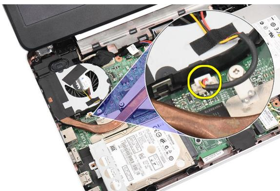
6. Rimuovere le viti che fissano il gruppo del dissipatore di calore e della ventola della CPU seguendo la sequenza nell'immagine.
